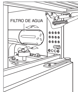
Extracción del filtro de agua
