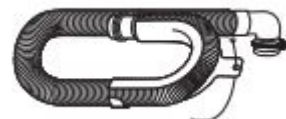
Manguera de desagote con abrazadera, molde en forma de U y atadura para cables
