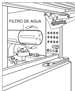
Extracción del filtro de agua
