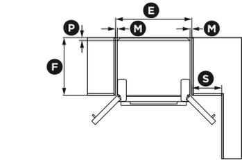
Châssis du réfrigérateur au même niveau que l'armoire – ouverture complète de la porte
