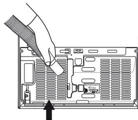
Nettoyage du couvercle de compartiment arrière
