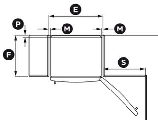
Châssis du réfrigérateur au même niveau que l'armoire - ouverture complète de la porte
