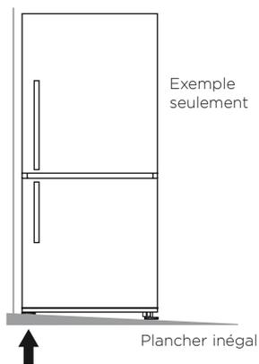
Ce pied se soulève du sol lorsque la partie supérieure avant du réfrigérateur est poussée doucement vers l'arrière
