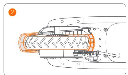
Nettoyez d'abord les corps étrangers, puis essuyez-les avec un chiffon doux et humide. Lubrifiez les deux côtés du roulement avec de l'huile de graissage ou de l'huile de machine. Si le problème persiste, veuillez contacter le service client.
