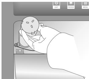
Réinitialiser filtre à eau dans le menu des paramètres ou en appuyant sur la touche Enter ✓ pendant 5 secondes.
