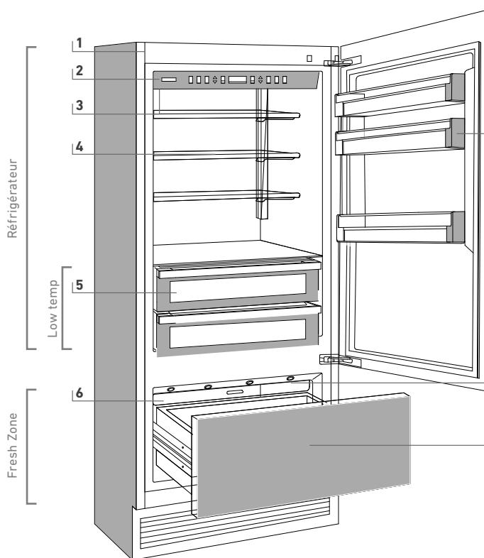
**1** Structure en acier inox avec finitions en aluminium
