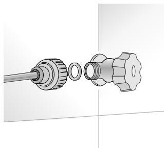
Les modèles dotés de dispositif pour la production de glaçons (Appareil à glaçons) nécessitent d'un raccordement au réseau hydraulique domestique. Celui doit être réalisé moyennant le tuyau de remplissage d'eau avec un filet de  $\frac{3}{4}$ " fourni.
