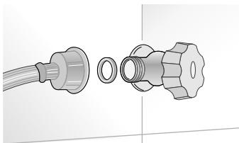
Los modelos equipados con máquinas de hacer hielo requieren una conexión al sistema de suministro de agua doméstico. Esta conexión puede llevarse a cabo a través de la línea de agua de 1/4 "(cobre o polietileno) hasta el suministro de agua de la casa. La presión del sistema debe estar entre 8 psi y 75 psi (entre 0,5 bar y 5 bar).
