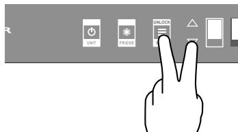
Afin d'éviter la modification accidentelle des configurations, le clavier se bloque automatiquement après un certain temps et sur l'écran apparaît le message "keypad locked". Pour le réactiver, appuyer en même temps sur les touches Menu et Up/Down pendant au moins 3 secondes. Le verrouillage des touches peut être désactivé grâce à la fonction spécifique dans le menu «Settings».
