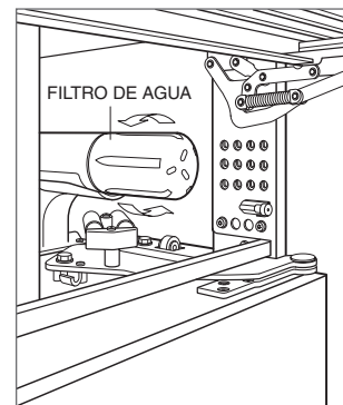
Extracción del filtro de agua
