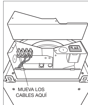
Ubicación del cableado
