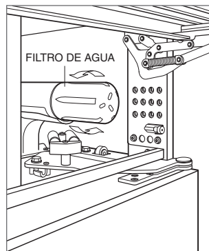
Extracción del filtro de agua.
