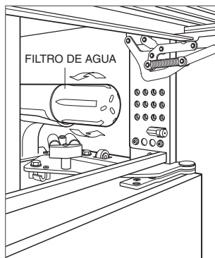
Extracción del filtro de agua.
