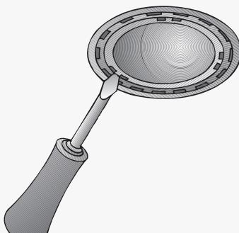
3. Remplacez l'ampoule à halogène (ampoule à halogène classique, 12 volts, 20 watts maximum, douille G4).
