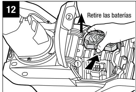
**AVISO:** asegúrese de que el pestillo del soplador de nieve encaje en su lugar y de que los paquetes de baterías estén fijos en la unidad antes de comenzar a usar la herramienta.
