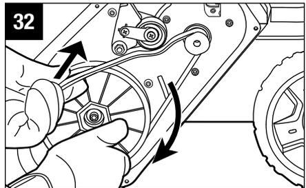
5. Utilisez des pinces à bec effilé pour installer le ressort sur le crochet de manière à retendre la courroie d'entraînement (Fig. 29).
