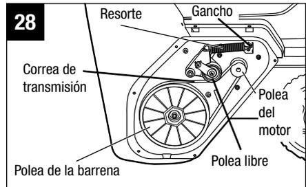
2. Use un par de pinzas de punta fina (no se incluyen) para retirar el resorte del gancho y soltar la correa de transmisión (Fig. 29 y 30).
