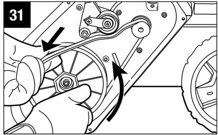
**Conseils :** Faites d'abord tourner la courroie d'entraînement neuve autour de la poulie du moteur, puis autour de la poulie libre et enfin autour de la poulie de la vis sans fin. Tournez lentement la poulie de la courroie d'entraînement de la vis sans fin dans le sens des aiguilles d'une montre vers l'intérieur (Fig. 28).
