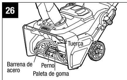
2. Utilice un destornillador de cabeza plana (no incluido) para aflojar completamente los dos pernos ubicados en un lado y retire los dos pernos y las dos tuercas para retirar la paleta de goma de la barrena de acero.
