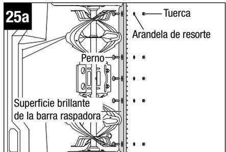
5. Coloque las arandelas de resorte y las tuercas en los pernos (desde la parte exterior de la plataforma) y utilice una llave para tuercas (no se incluye) para asegurar con firmeza la barra raspadora a la plataforma (Fig. 25b).
