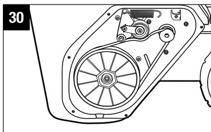
3. Retirez la courroie d'entraînement en tournant lentement la poulie de la vis sans fin dans le sens contraire des aiguilles d'une montre tout en tirant la courroie vers l'extérieur (Fig. 31).
