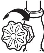
**9 CONNECT THE TUBING TO THE REFRIGERATOR**
