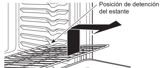
Retiro de los estantes
