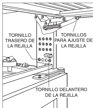
Tornillos para montaje de la rejilla
