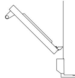
En maintenant la porte à 45°, alignez soigneusement les languettes de charnières avec les fentes de charnières. Poussez la porte vers l'intérieur jusqu'à ce que les verrous soient bien en place de chaque côté.
