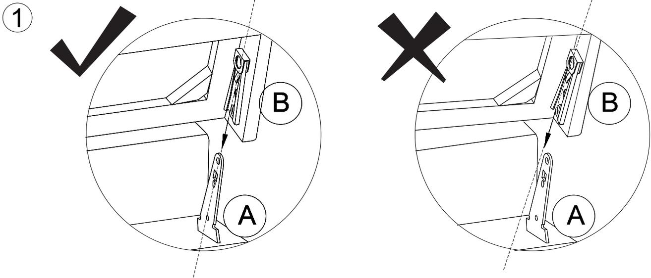
Assurez-vous d'aligner les deux clips de récepteur de chaque côté du dos inclinable (B) avec les deux bras de support (A) dans la base de la chaise à la ligne centrale.
