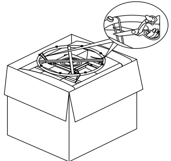
Par le dessous de la Base du siège (a) couper soigneusement les courroies enroulées autour du mécanisme métallique et le rail de bois de l'avant et à l'arrière.
