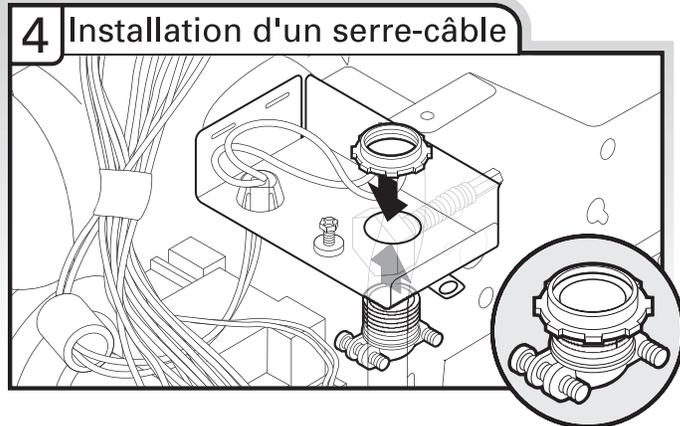
Installer un serre-câble (homologation UL ou CSA). Veiller à ce que les têtes de vis soient orientées vers la gauche après le serrage de l'écrou du conduit. Le serre-câble est fourni avec le cordon d'alimentation.
