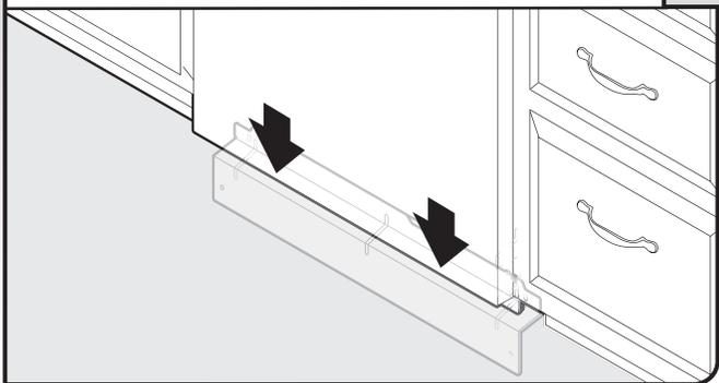
Vérifier que la rive inférieure du panneau inférieur est au contact du plancher. Le réajuster au besoin.
