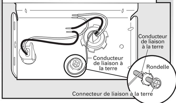
Ôter la vis verte de liaison à la terre et la placer à travers la borne en anneau de la vis verte de mise à la terre. Fixer à nouveau la vis verte et la serrer.
