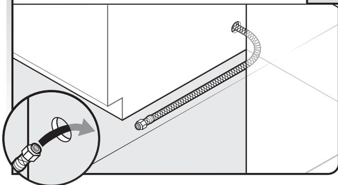
Faire passer prudemment la canalisation d'alimentation en eau à travers le trou percé dans le placard. (Le tube de cuivre peut s'écraser/se déformer facilement lors d'une flexion; procéder prudemment.) Il faut que la longueur de la section qui dépasse dans l'espace d'encastrement soit suffisante pour le raccordement à l'entrée du lave-vaisselle sur le côté gauche/à l'avant du lave-vaisselle.
