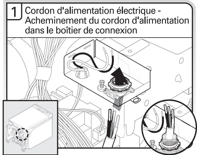
Acheminer le cordon d'alimentation de façon à ce qu'il ne touche pas la zone située entre le moteur du lave-vaisselle et la partie inférieure de la cuve du lave-vaisselle. Tirer le cordon pour l'acheminer à travers le serre-câble dans le boîtier de connexion.
