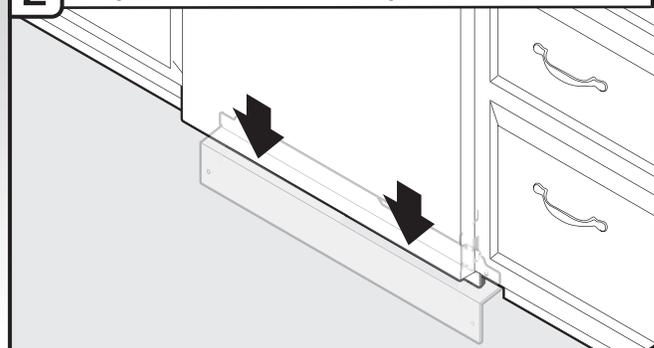
Vérifier que la rive inférieure du panneau d'accès est au contact du plancher. La réajuster au besoin.
