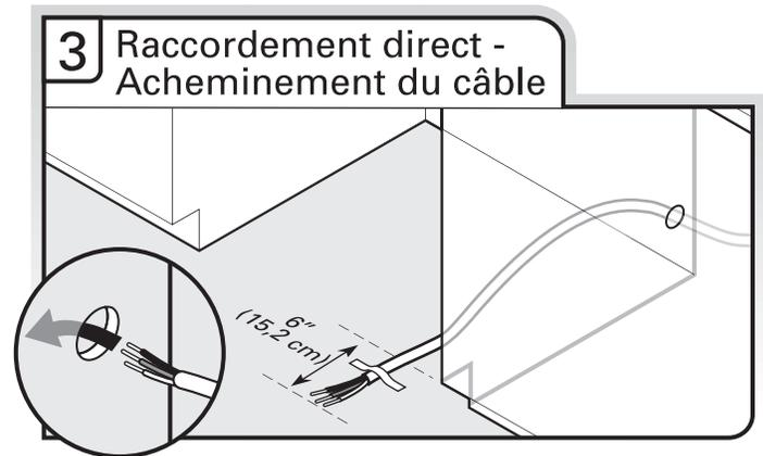
Acheminer le câble de la source d'alimentation électrique à travers le trou dans le placard (le câble doit dépasser par le côté avant droit de l'ouverture d'encastrement du placard).
