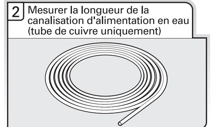
Mesurer la longueur totale du tube de cuivre pour la canalisation d'alimentation en eau.
