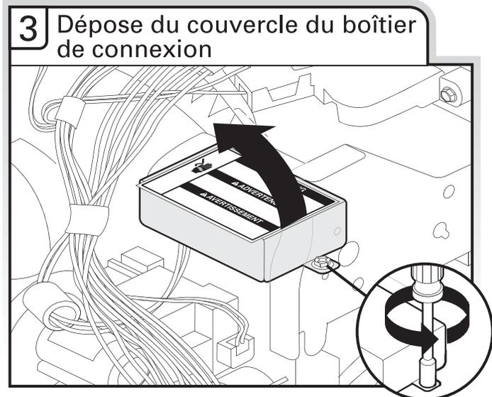
Utiliser une clé à douille hexagonale, un tourne-écrou de 1/4" ou un tournevis Torx® T20®; démonter le couvercle du boîtier de connexion; conserver les pièces pour réutilisation éventuelle.
