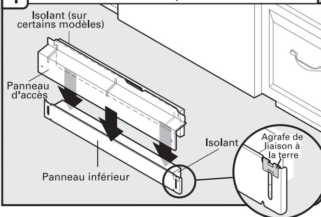
Vérifier que l'agrafe de liaison à la terre est fixée sur le panneau inférieur. Placer le panneau inférieur derrière le panneau d'accès. Sur certains modèles, il y a sur le panneau d'accès un matériau isolant qui devra être inséré derrière l'isolant du panneau inférieur.
