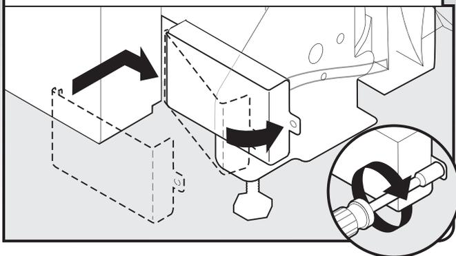
Placer les conducteurs à l'intérieur du boîtier de connexion. Insérer les languettes du côté gauche du couvercle. S'assurer que les fils sont bien logés à l'intérieur du boîtier. Fermer le couvercle tout en veillant à ne pas coincer de fils. Fixer le couvercle à l'aide d'un tourne-écrou de 1/4" ou d'un tournevis Torx® T20® et de la vis précédemment retirée.
