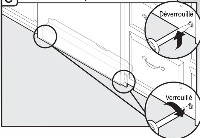
À l'aide d'un tournevis à lame plate, tourner les dispositifs de fixation d'un quart de tour dans le sens horaire pour les emboîter. L'encoche des dispositifs de fixation est complètement à la verticale lorsqu'ils sont correctement emboîtés.
