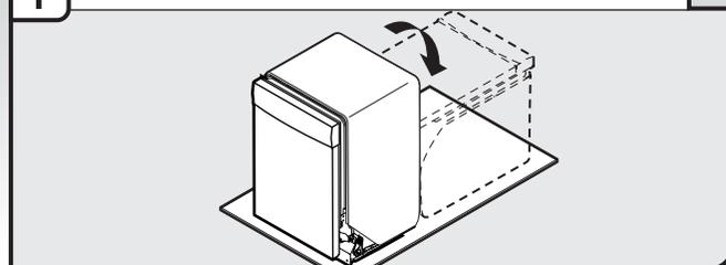
**Conseil utile :** Pour éviter d'endommager le revêtement de sol, placer une feuille de carton sous le lave-vaisselle jusqu'à son installation dans la cavité d'encastrement. Ne pas utiliser le panneau de porte comme surface de travail sans d'abord l'avoir recouvert d'une serviette pour éviter de l'endommager.
