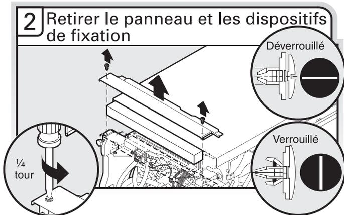
À l'aide d'un tournevis à lame plate, tourner les dispositifs de fixation d'un quart de tour dans le sens antihoraire pour les déverrouiller. Retirer le panneau. Ne pas retirer la fiche technique du panneau d'accès.
