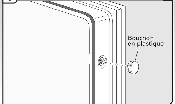
Dans le cas de la fixation sur les placards latéraux, vérifier que les côtés de la porte ne frottent pas contre les têtes de vis. S'il y a frottement, centrer à nouveau le lave-vaisselle. Une fois le lave-vaisselle correctement centré, réinstaller les bouchons d'obturation de plastique.
