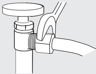
Fixer la canalisation d'alimentation en eau (tube de cuivre ou canalisation flexible à tresse d'acier) à la canalisation d'eau chaude à l'aide d'une configuration de raccordement qui soit conforme à tous les codes et règlements locaux. La canalisation d'alimentation en eau raccordée au lave-vaisselle doit comporter un robinet d'arrêt manuel situé sous l'évier.
