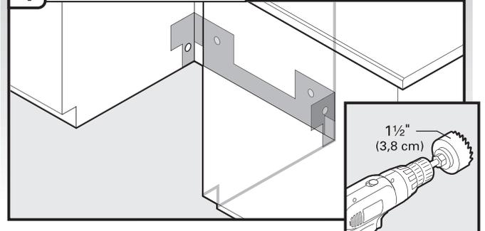
Si nécessaire, percer un trou de 1/2" (3,8 cm) de diamètre dans la paroi du placard ou le côté de l'ouverture le plus proche de l'évier.
