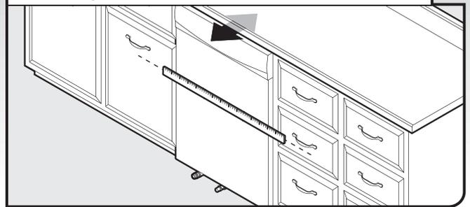
Aligner l'avant du panneau de porte du lave-vaisselle avec les portes des placards. Il faudra peut-être ajuster l'alignement de celui-ci pour qu'il soit en affleurement avec les placards.
