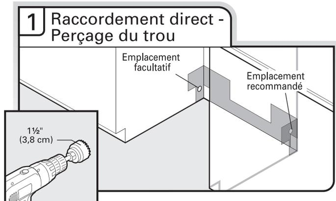
Percer un trou de 1 1/2" (3,8 cm) dans le côté droit de la paroi latérale ou arrière du placard.
