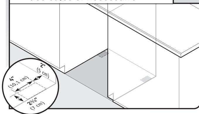
Planchers surélevés (la hauteur du plancher de la cuisine est supérieure à celle de l'ouverture d'encastrement du placard). Par exemple, le carrelage du plancher de la cuisine n'arrive pas jusque dans l'ouverture du placard : ajouter des cales selon le besoin dans la zone indiquée pour placer le lave-vaisselle à une hauteur maximale de 34" (86,4 cm) sous le plan de travail.
