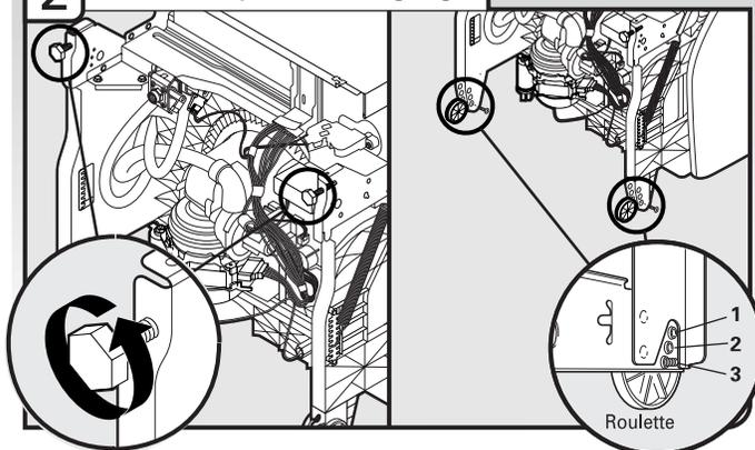
Régler les deux pieds de nivellement à la même hauteur. Placer les roues à la position requise déterminée à partir du "Tableau de réglage de la hauteur du lave-vaisselle".
