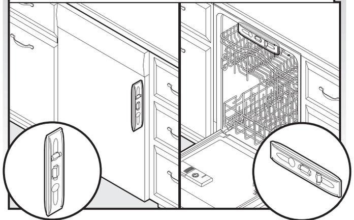
Vérifier que le lave-vaisselle est toujours d'aplomb d'avant en arrière et transversalement dans l'ouverture d'encastrement du placard.
