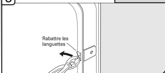
Enfoncer la bride dans la fente sur le côté du lave-vaisselle et replier la languette vers le côté du lave-vaisselle afin de maintenir la bride en place. Répéter cette étape pour l'autre côté du lave-vaisselle.
