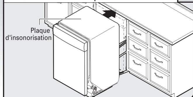
**IMPORTANT :** Si l'on enlève les roulettes, protéger le plancher pour éviter de l'endommager lors des déplacements du lave-vaisselle. Insérer lentement et complètement le lave-vaisselle dans l'ouverture d'encastrement du placard. Veiller à ne pas coincer ou déformer la canalisation de cuivre, le tuyau d'évacuation, le cordon d'alimentation ou le câble de raccordement direct entre le lave-vaisselle et le placard. Enlever le carton placé sous le lave-vaisselle.
