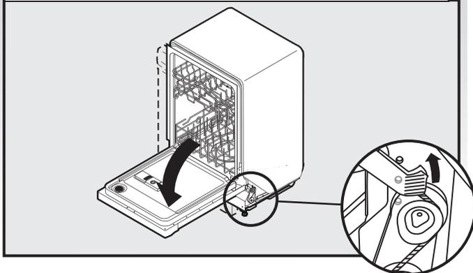
Lorsque la porte est déverrouillée, si elle s'ouvre d'elle-même, déplacer le tendeur vers un trou numéroté inférieur et replacer la vis. Fixer à nouveau le ressort de la porte au pied arrière.
