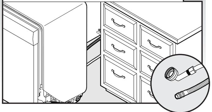
Vérifier que la canalisation d'eau se trouve sur le côté gauche de l'ouverture du placard, et que le tuyau d'évacuation se trouve près du centre de l'ouverture du placard.
