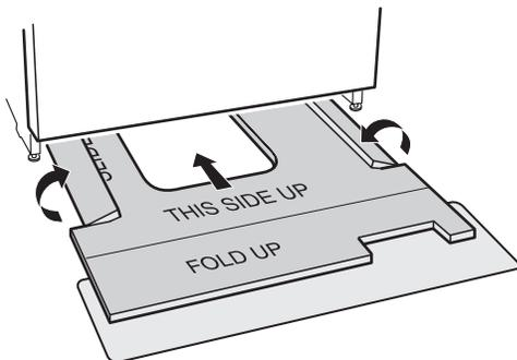
4. Plier l'avant de la plaque en position. Vérifier que la plaque de vinyle est insérée derrière la porte et les pieds avant du lave-vaisselle comme illustré.
