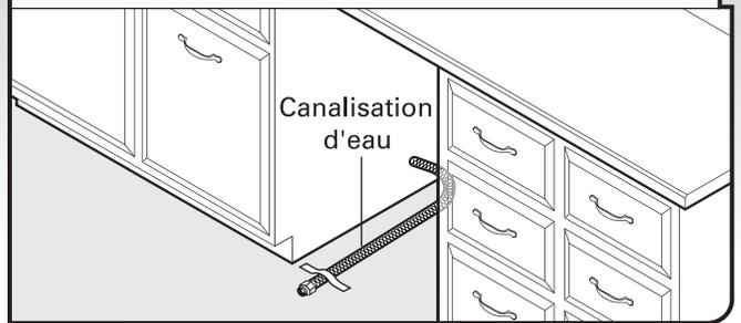
Installer la canalisation d'alimentation en eau et la fixer au plancher avec du ruban adhésif dans la zone indiquée. Cela l'empêchera de bouger lors de l'insertion du lave-vaisselle dans l'ouverture du placard.
