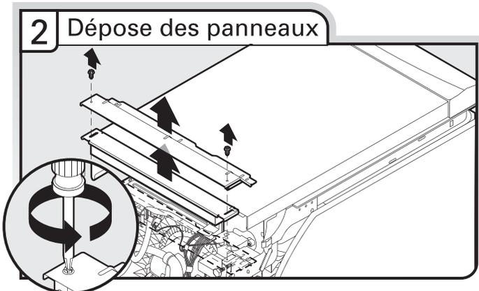
À l'aide d'une clé à douille, un tourne-écrou ou un tournevis Phillips de 1/4", ôter les deux vis fixant le panneau d'accès et le panneau inférieur au lave-vaisselle. Ne pas retirer la fiche technique du panneau d'accès.
