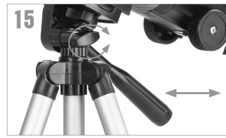
Um das Teleskop nach rechts und links zu schwenken, halten Sie ein Stativbein mit einer Hand fest, während sie mit der anderen Hand das Teleskop mit dem Schwenkgriff bewegen. Die Azimut-Feststellschraube kann gelöst oder angezogen werden, um die Spannung nach Ihren Wünschen einzustellen.
