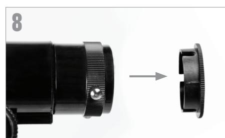
Retirez le capuchon de l'extrémité du système de mise au point du tube du télescope, et vérifiez que les deux vis à main ne dépassent pas dans l'ouverture.
