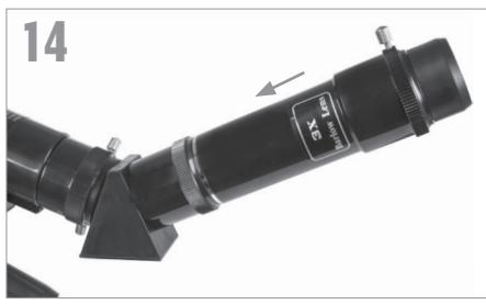
Sie können für eine zusätzliche Vergrößerung die mitgelieferte 3-fach Barlowlinse verwenden. Stecken Sie die Barlowlinse zwischen Zenitspiegel und Okular.
