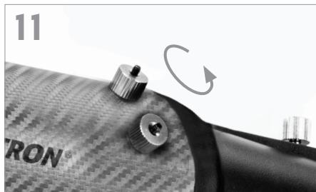
Entfernen Sie die Rändelmuttern von den Gewindestangen am Fokussiererende des Teleskopstubs.
