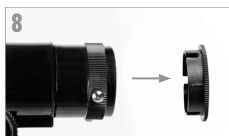
Entfernen Sie die Kappe vom Fokussierende des Teleskopohrs und stellen Sie sicher, dass die beiden Rändelschrauben nicht in die Öffnung hineinragen.
