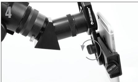
Lösen Sie den Knopf auf der Unterseite des Adapters, mit dem die Telefonklammer an der Okularklemme befestigt ist. Schieben Sie die Telefonklammer nach oben und unten und drehen Sie sie nach links und rechts, bis Ihre Kamera durch das Okular des Teleskops nach unten schaut. Ziehen Sie den Knopf auf der Unterseite des Adapters fest, um ihn zu sichern.
