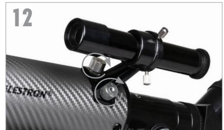
Trouvez le chercheur dans la boîte et retirez les capuchons de plastique de l'avant et de l'arrière de la lentille. Orientez le chercheur de manière à ce que l'objectif plus grand soit orienté vers l'avant du tube, comme illustré. Positionnez le chercheur sur les supports du tube et remettez les écrous striés en place pour le fixer.
