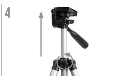
Per estendere il montante centrale del treppiedi, ruotare la manopola di blocco in senso antiorario, sollevare la testa del treppiedi fino all'altezza desiderata e ruotare la manopola di blocco in senso orario per assicurare.
