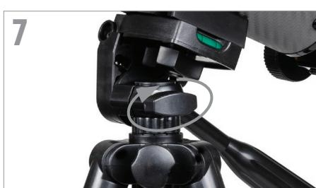
Rotare la piattaforma di montaggio in modo che sia orizzontale e stringere la manopola per assicurarla.
