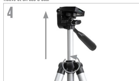
Pour étendre la colonne centrale du trépied, faites tourner la molette de verrouillage dans le sens inverse des aiguilles d'une montre, levez la tête du trépied jusqu'à ce qu'elle ait atteint la hauteur désirée puis faites tourner la molette de verrouillage dans le sens des aiguilles d'une montre.
