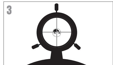
Schauen Sie durch das Sucherfernrohr und suchen Sie das Fadenkreuz. Schwenken Sie das Teleskop weiter, bis das Fadenkreuz über dem Mond erscheint.
