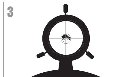
Regardez dans le chercheur et localisez le réticule du viseur. Continuez à orienter le télescope jusqu'à ce que le viseur soit superposé sur la Lune.
