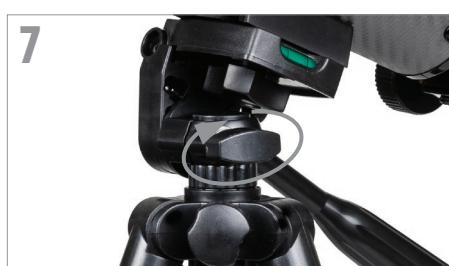
Gire la plataforma de montaje de forma que quede horizontal y apriete el mando para asegurarlo.
