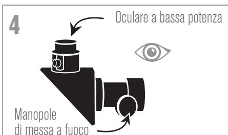
Osservare attraverso l'oculare da 20mm del telescopio. Ruotare con cura le manopole di messa a fuoco per regolare la nitidezza dell'immagine.
