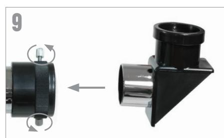
Trouvez le renvoi coudé dans la boîte et retirez les capuchons de plastique. Insérez le bâillet du renvoi coudé dans le système de mise au point et fixez-le en serrant les vis à main.
