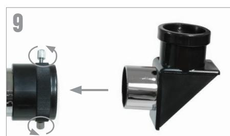
Localice la diagonal de imagen recta y saque las tapas de plástico. Introduzca el cañón de la diagonal en el enfoque y asegúrela en posición apretando los tornillos.
