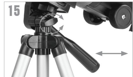
Pour orienter le télescope vers la droite et la gauche, tenez un pied du trépied d'une main, et de l'autre, utilisez la poignée d'orientation pour déplacer le télescope. La vis de verrouillage d'azimut peut être desserrée ou serrée pour régler la résistance comme désiré.
