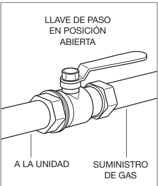
Llave de paso del suministro de gas
