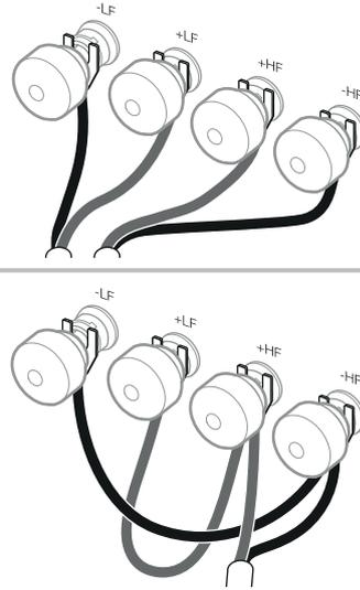
Her bir hoparlörün arkasında, çift kablolu imkanı sağlayan iki çift terminal yer almaktadır (üstte). Tekli kablo bağlantısı için ürün ile birlikte verilen bağlantı kablolarını benzer kutup terminallerini birleştirmek için yerleştirin. İki-kablolu bağlantı, alçak seviyedeki ayrıntıların çözünürlüğünü artırabilir.
