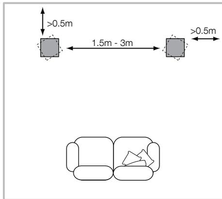
先选好扬声器在室内的位置后，再安装和调整钉脚/橡胶脚可能会更方便。安装或更换钉脚/橡胶底座时，先从包装中取出扬声器，小心地将扬声器侧放，方便接触底座的底面。放倒音箱时，建议将音箱放置在柔软、无凸起的表面上，确保不损坏饰面。安装好钉脚/橡胶支脚后，即可扶起扬声器，放到合适的位置。
