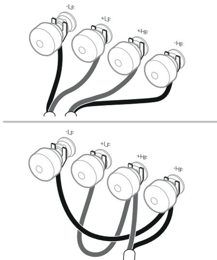
Na zadní straně každé reprosoustavy jsou pak dva páry terminálů, dovolující zapojení Bi-Wire (vlevo). Při klasickém způsobu zapojení, spojte dodávanými propojkami terminály se stejnou polaritou (vpravo). Zapojení Bi-Wire obvykle zlepší rozlišení jemných detailů.
