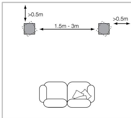
スピーカーの位置が部屋の中で最適化された後に、スパイク/ゴム足の調整をした方が便利な場合があります。スパイク/ゴム足を取り付けたり、交換したりする場合は、箱からスピーカーを取り出した後、スピーカーを慎重に横に倒すと、底面の調整がしやすくなります。スピーカーを降るす際には、表面を傷つけないように、柔らかくて傷が目立たない場所に置くことをお勧めします。スパイク/ゴム足を取り付けたら、スピーカーを所定の位置に持ち上げることができません。
