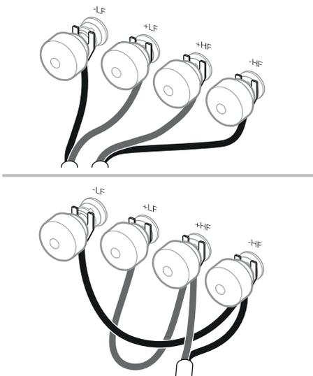
每台揚聲器的背部均有兩對插座，可用於雙線連接(上)。對於傳統的單線連接，使用隨附的接線與同極性的插座相連。雙接連線可改善低層次細節的解析度。
