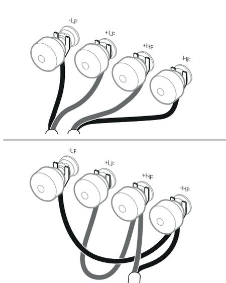
На задней панели колонок имеются по две пары клемм, чтобы обеспечить возможность подключения би-ваерингом (двухкабельное, bi-wiring, см. выше). Для обычного, однокабельного подключения, подсоедините проводники к клеммам соответствующей полярности. Би-ваеринг может улучшить разрешение деталей низкого уровня.
