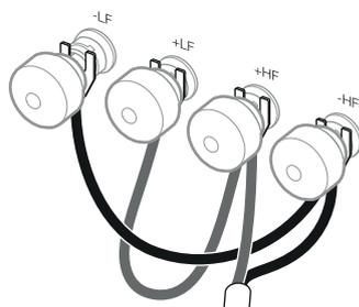
En la parte posterior de la caja acústica hay dos pares de terminales de conexión para facilitar el bicableado (arriba). Para realizar una conexión convencional en monocableado, coloque los puentes suministrados de serie de tal modo que los terminales positivos y los terminales negativos estén unidos entre sí (es decir, positivo a positivo y negativo a negativo). El bicableado puede mejorar la resolución de los detalles de bajo nivel.
