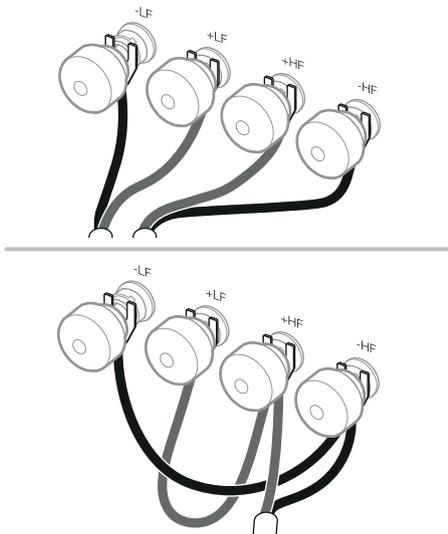
各スピーカーの背面には、バイ・ワイヤリングが可能な2組の端子があります(トップ図参照)。従来のシングル・ワイヤ接続を行う場合は、付属のリンク・ワイヤで同じ極性の端子をつないでください。バイ・ワイヤリングにすると低域のディテールのレゾリューションを改善することができます。
