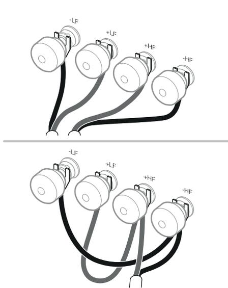
Két pár csatlakozóaljzat található a hangszugárzó hátulján, ezáltal kettős kábelezésre alkalmas. Hagyományos bekötéskor, használja a mellékelt áthidaló kábeleket és kösse össze az azonos polaritásúkat. A kettős kábelezés javítja az alacsonyfrekvenciás részletek felbontását.
