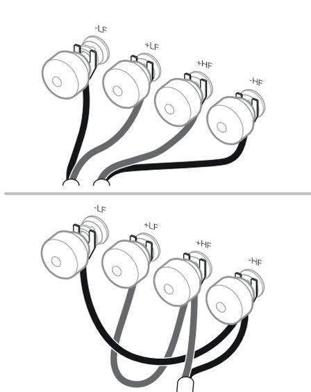
Υπάρχουν δύο ζεύγη ακροδεκτών στο πίσω μέρος κάθε ηχείου που επιτρέπουν τη σύνδεση με δύο καλώδια (επάνω). Για σύνδεση με ένα καλώδιο, τοποθετήστε τα παρεχόμενα καλώδια σύνδεσης για να ενώσετε τους ακροδέκτες ίδιας πολικότητας μεταξύ τους. Η σύνδεση με δύο καλώδια μπορεί να βελτώσει την ανάλυση των λεπτομερειών χαμηλού επιπέδου.
