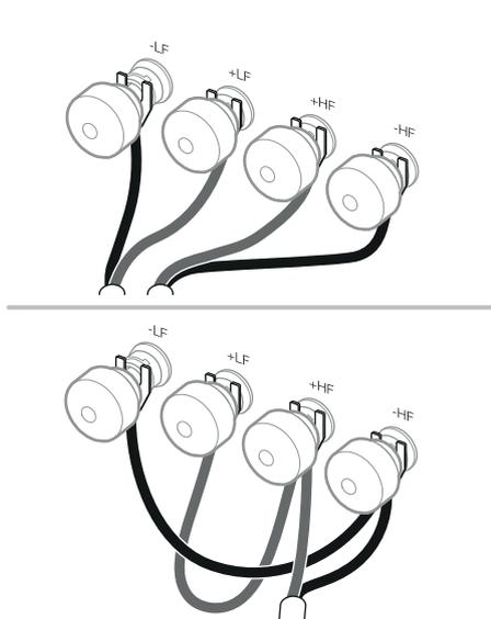
Existem dois pares de terminais na parte de trás de cada coluna que possibilitam uma cablagem dupla (topo). Para uma ligação simples, encaixe os cabos de ligação fornecidos de forma a ligar os terminais com a mesma polaridade. A cablagem dupla pode melhorar a resolução dos detalhes de níveis mais baixos.
